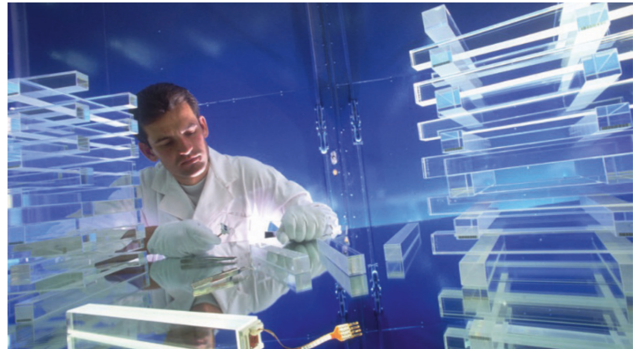
Test der PbWO 4 -Kristalle für den CMS-Detektor am CERN
